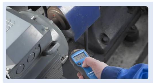
雷射光學系統,可以容易 及快速在轉動機械的安全 距離上進行量測。
